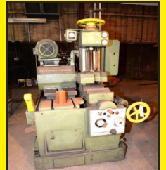
BURKHARDT & WEBER COLD CUT SAW, MD. #HKS630 - AUFTRAGS-NR14 379 - STERLING 5HP MOTOR, GUSHER COOLANT PUMP
